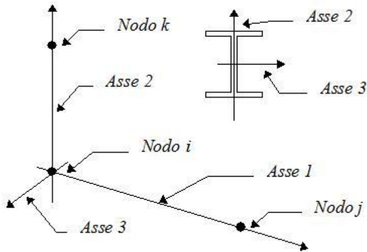
Vengono riportati i valori di efficacia dei vincoli alle estremità dello elemento (variabili fra 0 e 100%), nei due piani 1-2 e 1-3 della trave in corrispondenza dei nodi, dando quindi la possibilità di considerare aste non perfettamente incastrate (coefficienti  $V_{i12}$ ,  $V_{j12}$ ,  $V_{i13}$ ,  $V_{j13}$ ).
